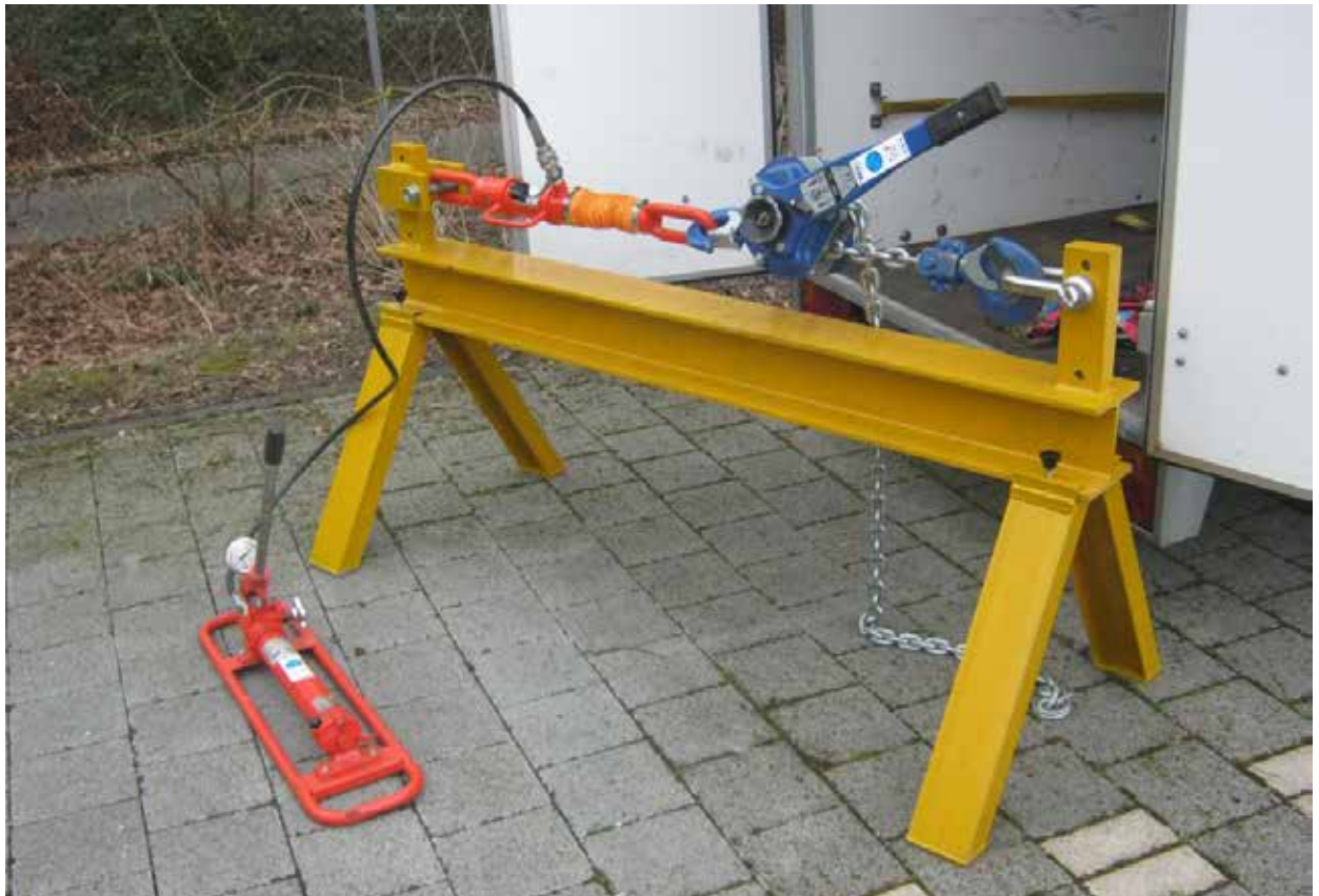
Eigenbau eines zerlegbaren mobilen Prüfstandes zur dynamischen Prüfung von Handhebezeugen.
