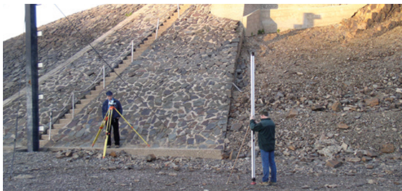
Abb. links: Überwachungs- messungen an der Rurtalsperre Schwammenauel, Wasserseite des Dammes
